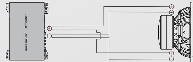
Serial wiring: 4 Ohm
